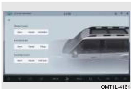
Cambie la alimentación del vehículo al modo ON, a través de la pantalla de la ventana en la pantalla multimedia, haga clic en él para ajustar el parasol, el techo corredizo y la ventana.
