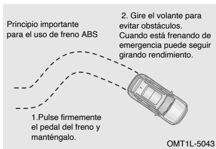
El ABS no funciona durante el frenado normal y se encenderá inmediatamente solo durante el frenado de emergencia (el pedal del freno pulsa con ruido, garantizando el rendimiento de frenado y el rendimiento de la dirección, si el espacio es suficiente, el vehículo también puede evitar obstáculos). Nunca suelte el pedal del freno en este caso.
