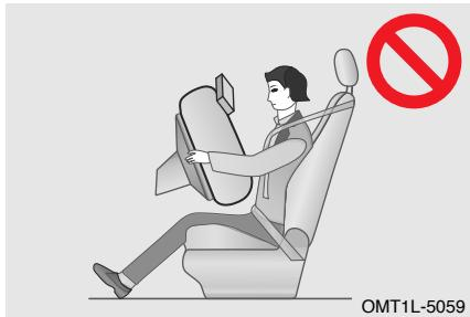
Es posible que el airbag lateral del asiento delantero y el airbag lateral de cortina (si está equipado) no se desplieguen si el vehículo sufre una colisión frontal o trasera, un vuelco o una colisión lateral a baja velocidad.
