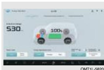
La energía fluye del motor al motor eléctrico, parte de la cual se utiliza para conducir las ruedas delanteras y parte para cargar la batería.
