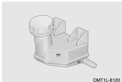
El nivel de líquido de frenos debería encontrarse entre las marcas "MIN" y "MAX". Si el nivel es igual o inferior a la marca "MIN", agregue el líquido de frenos y contacte con la estación de servicio autorizada de Jetour para su inspección y reparación de inmediato.
