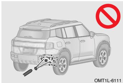
Cuando lave el vehículo, usa un paño suave o agua (baja presión de agua) para lavar la materia extraña como nieve, barro y polvo en la superficie del sensor de radar.
