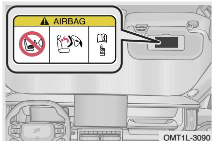
Esta pegatina está pegada en el visera del pasajero delantero y se utiliza para recordarle que el vehículo está equipado con airbag delantero (SRS). Se observen las siguientes precauciones:
