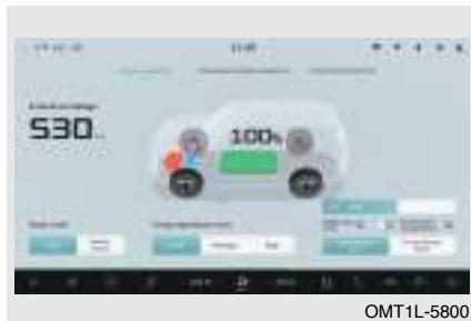
La energía fluye de la batería de alimentación al motor eléctrico y a continuación el motor eléctrico acciona las ruedas delanteras.
